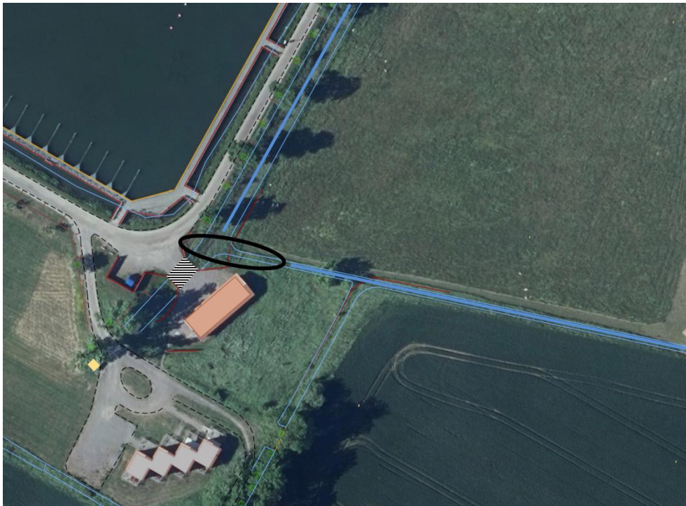
Bild. Bilden visar område som idag är kulverterat (skrafferat) och ungefärligt område för behovet av ny kulvertering för angöringsvägen (svart oval). Befintliga diken markerade med blå kulör. Befintlig servicebyggnad markerad med orange färg. (Kommunens kartunderlag, primärkarta)
